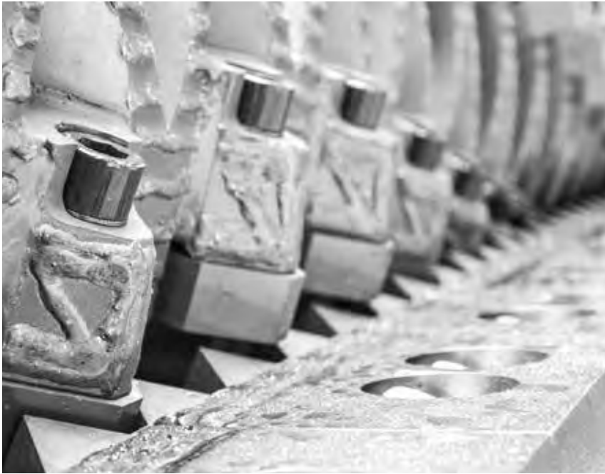
PowerLine Schnittspalt zwischen Rotor und Gegenmesser
