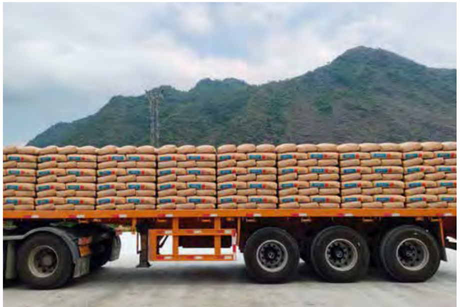
Der BEUMER autopac ermöglicht durch die vollautomatische Beladung eine konstant hohe Stapelqualität (Bildnachweis: BEUMER Group GmbH & Co. KG)
