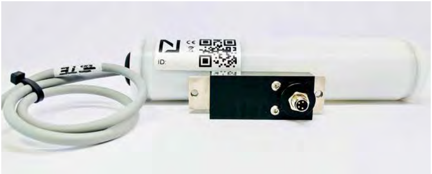
Der batteriebetriebene Sensor braucht keinen Stromanschluss
