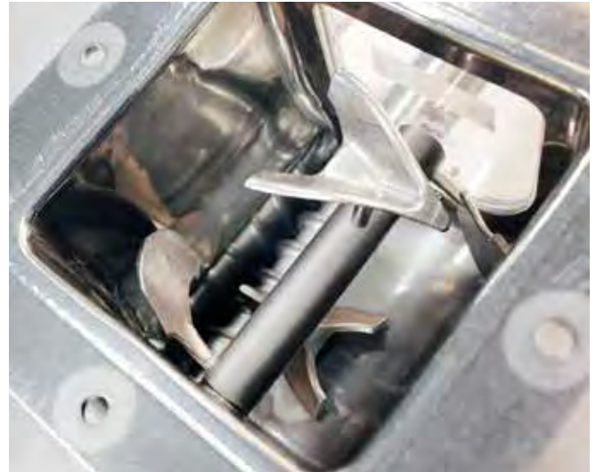
Die mit Pflugscharen und Schrägschaufeln bestückte Homogenisierwendel kombiniert effektive Homogenisierung mit gründlicher Austragung
